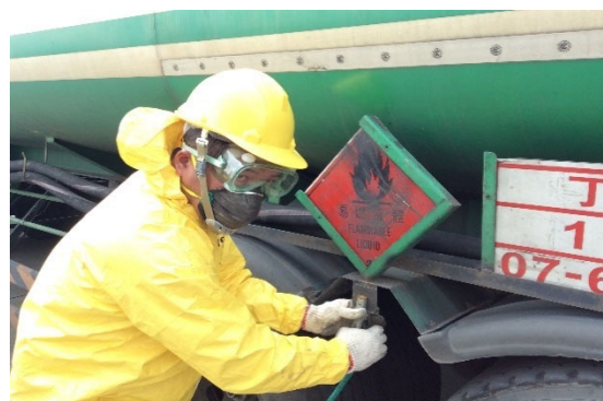
確認槽車是否有接妥接地線
